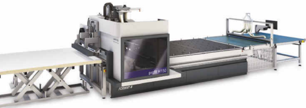
Die Nesting-CNC Profit H150 mit Beschick- und Abnahmetisch
