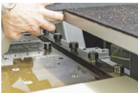
Rechts die Rollen des rechten Anschlags, links der Nocken für den Tiefenanschlag
