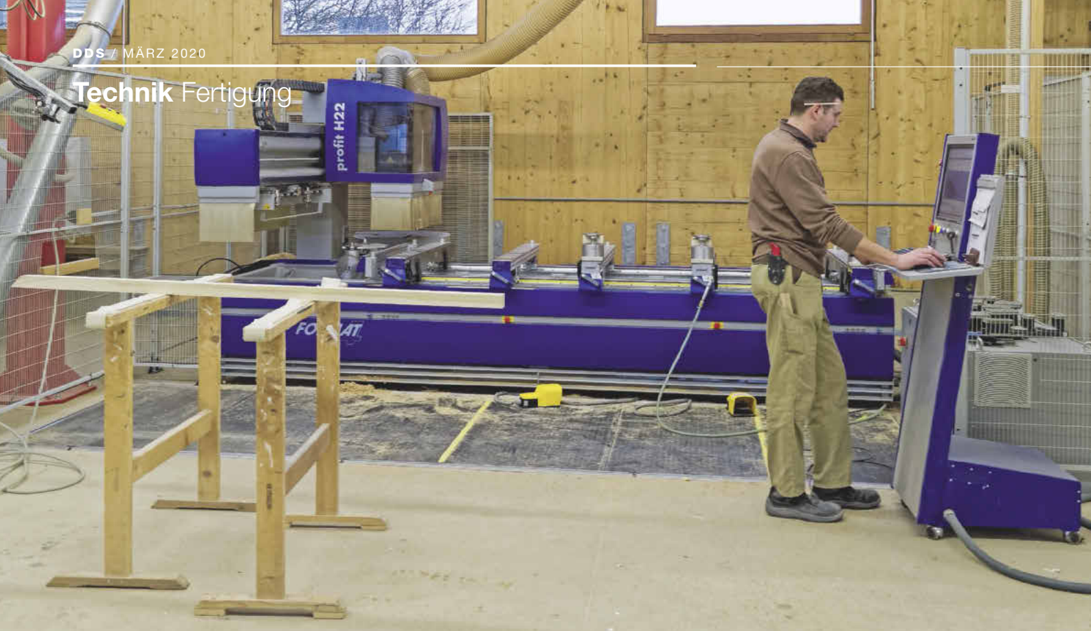
Thomas Mendl fertigt Türzargen an der fast elf Jahre alten Profit H22
