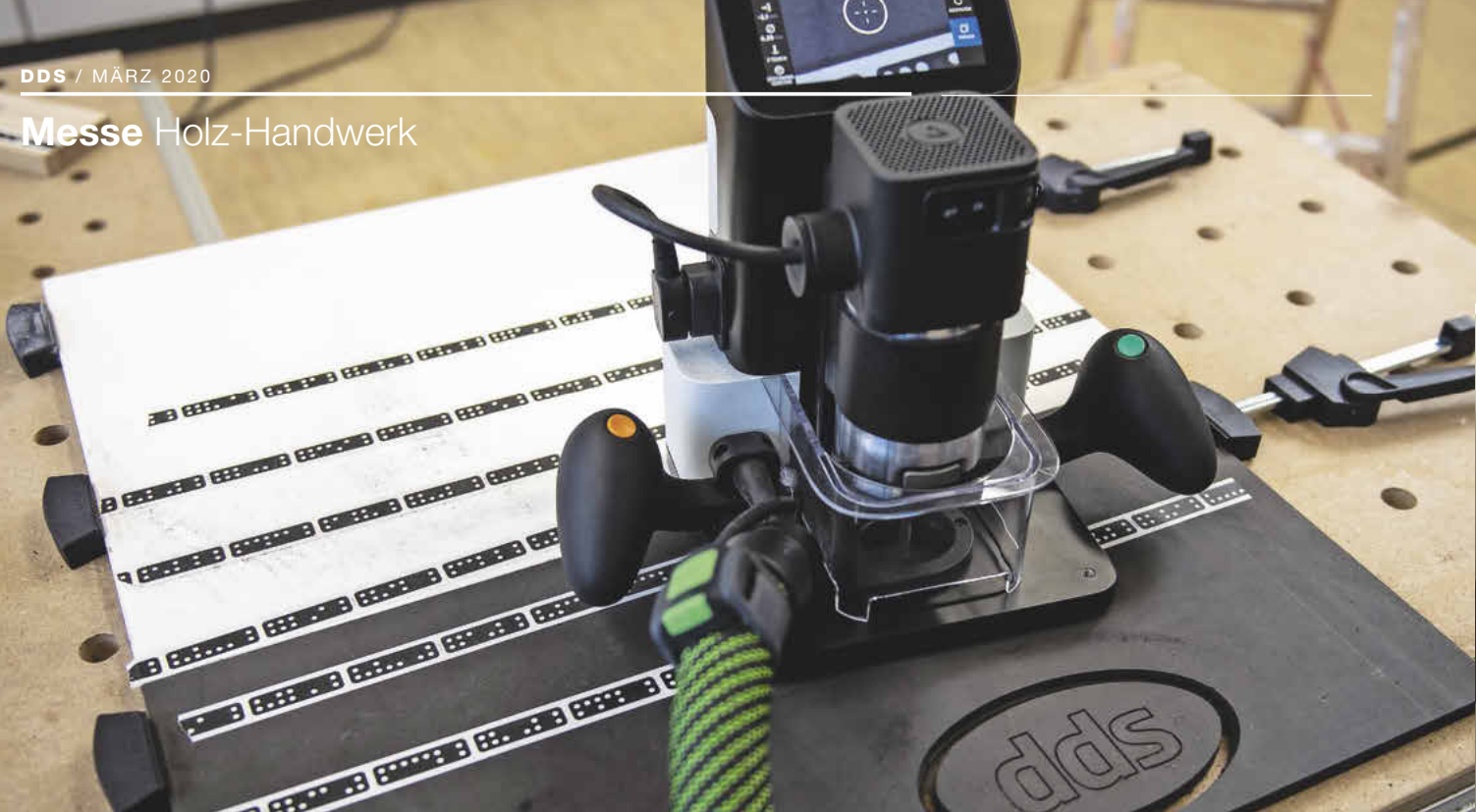
Digital fräsen von Hand – von nun an für jeden in Europa möglich. Hier ein Foto von den dds-Vorabtests mit der Oberfräse von Shaper Tools
