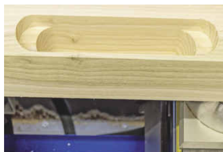
Ein frisch ausgefrästes Sackloch für unsichtbare Bänder
