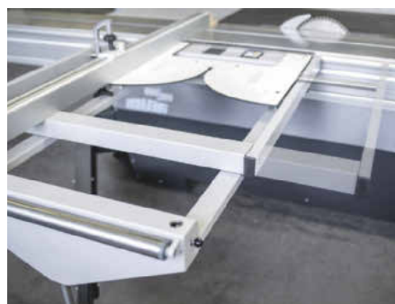
Der ausziehbare Teleskoprahmen passt sich der Werkstückgröße an
