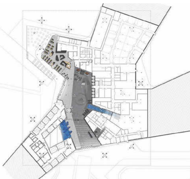
Bodenbelagsfarben markieren verschiedene Nutzungsbereiche
