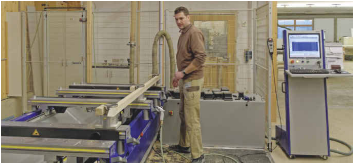
Die Blocksäuger für flächige Werkstücke hinten rechts hat Thomas Mendl gegen Spannzangen für stabförmige Teile getauscht
