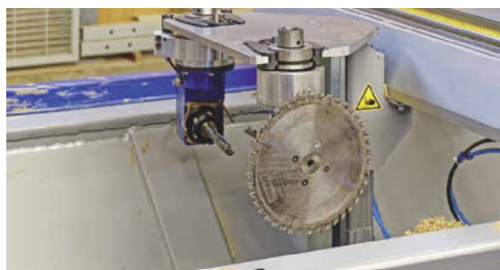
Das Magazin für große Werkzeuge mit Schlosskastenfräser und automatischer Schwenksäge
