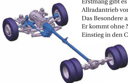
Antriebsstrang des VW Crafter mit permanentem Allradantrieb von Oberaigner
