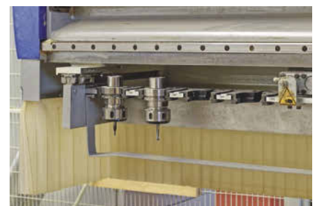
Neben einem mitfahrenden Werkzeugwechsler gibt es links noch einen weiteren
