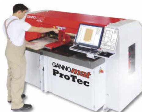
Die Arbeitsbreite der ProTec beträgt jetzt 1300 mm anstatt der bisherigen 1000 mm
