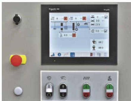
Die Aggregate der Q-Fin lassen sich jetzt bequem über den Touchscreen einstellen
