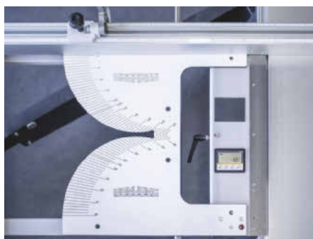
Der Winkelanschlag lässt sich nach einer flachen Digitalanzeige einstellen
