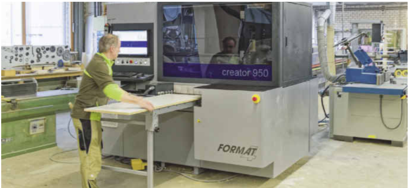
Josef Staudigl fertigt Korpusmöbelteile an der neuen Durchlauf-CNC
