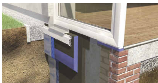
Anspruchsvoller Spezialfall: Bei bodentiefen Fensterelementen sind die Anschlüsse schwierig abzudichten
