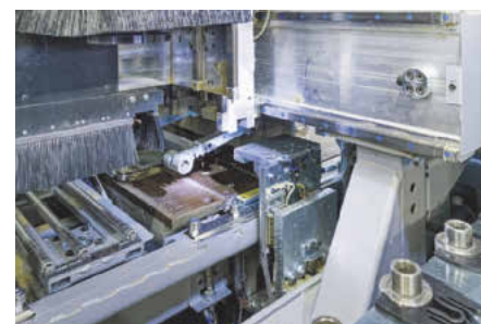
Unter dem Portal befindet sich eine Werkstückzange
