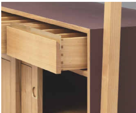
Die Griffprofile der Schubladendoppel sind mit 3 mm Messing hinterlegt
