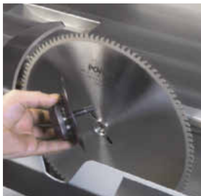
„Easy-Lock“ – Werkzeugloser Sägeblattwechsel
