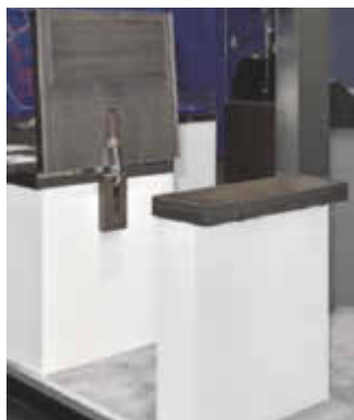
Entschärfte Gefahrenstelle: Tresenklappe mit Dämpfung
