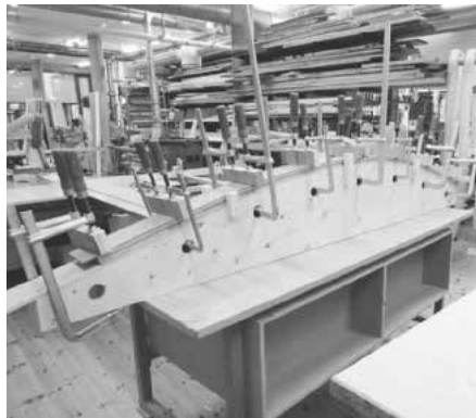
Ein gedämpftes Brett aus Birke wird zum Erkalten auf die Form gespannt
