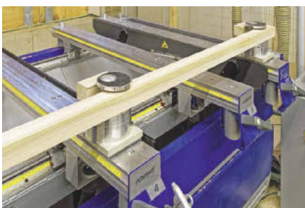
Die Holzklötze hinten verhindern ein Verkanten der Spannzangen
