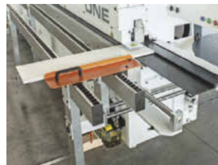
Bi-Matic: Teleskop-Transfer-System und 90°-Einschubwagen
