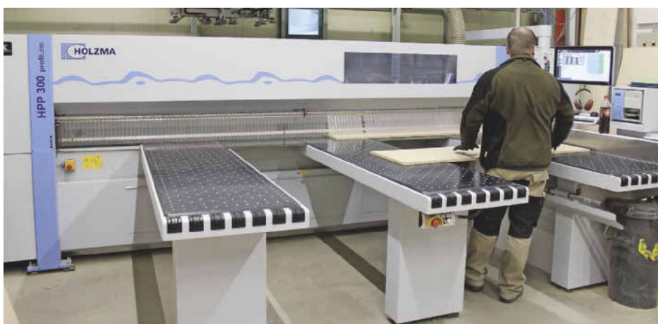
/ An der Plattenaufteilsäge HPP 300 Profiline (heute: Sawtec B-300 Profiline) erhält jedes Teil einen QR-Code zur Teileidentifizierung an den weiteren Fertigungsstationen.
