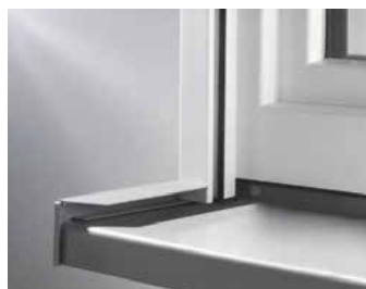
/ Das Putz-Aufsteckprofil wird auf Maß abgelängt und vor der Führungsschiene auf das Gleitendstück aufgesteckt.
