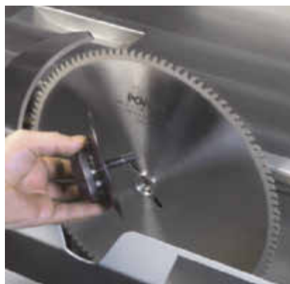
„Easy-Lock“ – Werkzeugloser Sägeblattwechsel
