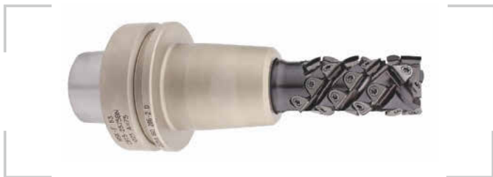
/ Auch beim neuen Konstantin-Fräser, dem Speedy-Mini-C247 (hier mit Schrumpffutter) lassen sich die Messer selbst wechseln bzw. ggf. untereinander tauschen.
