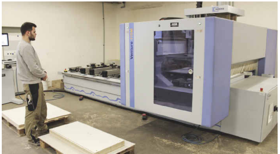
/ Seit 1996 hat Otterbach alle sechs Jahre die CNC gegen aktuelle Technik getauscht. Das 5-Achs-CNC-Bearbeitungszentrum BMG 110 Venture (heute: Centateq P-110) schafft mehr Bearbeitungsmöglichkeiten.
