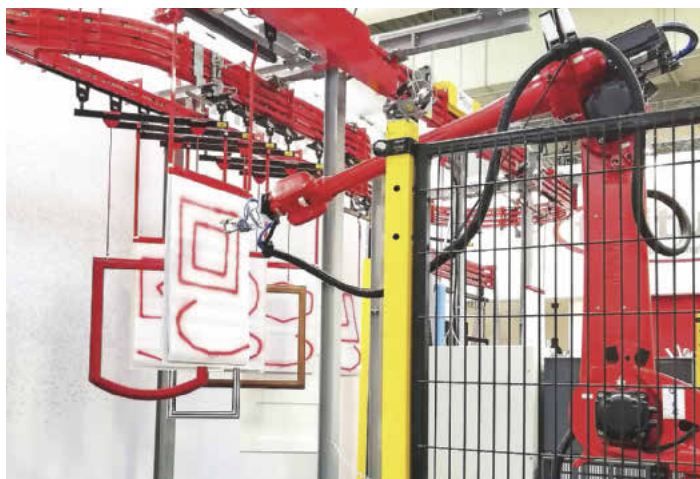
/ Die Spritzroboter für Fenster und Türrahmen von Finiture sind mit einer optimierten Version des herstellereigenen Winpaint-Programms ausgestattet.
