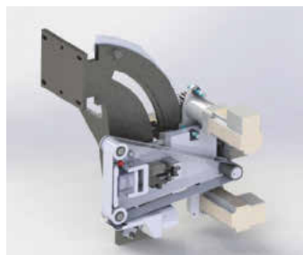
/ Das Fasenaggregat der Q-Fin-Spezialschleifmaschine ist optional verfügbar.
