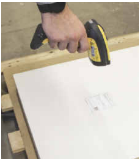
/ Direkt zum CNC-Programm: Teileidentifizierung per Hands scanner am Bearbeitungszentrum.
