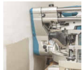
/ Die Säge kann dank doppeltem Zugmechanismus direkt an der Wand stehen.
