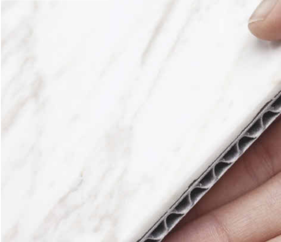
/ Blendstone gibt es in unterschiedlichen Varianten: Zum einen stehen verschiedene Natursteine zur Auswahl, zum anderen drei Arten von Trägermaterial. Im Bild: eine Aluwabe.
