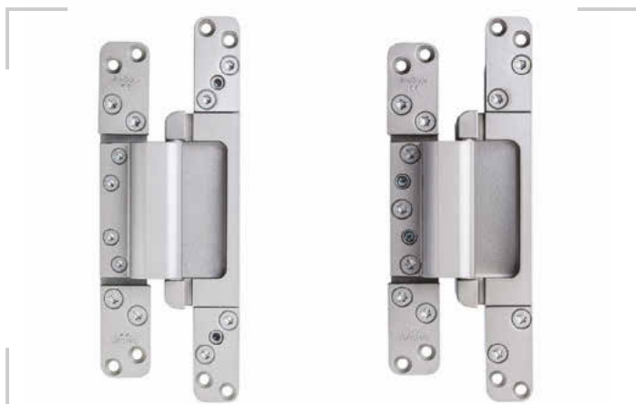
/ Links das alte Masterband FX2 120 3-D FD und rechts die optimierte Variante, wobei die seitliche Falzluftjustierung ins Zargenteil des Bandes verlagert wurde.
