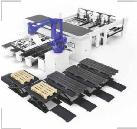
/ Wahlweise manueller oder vollautomatischer Betrieb: Plattenaufteilzentrum Sawtec B-300 FlexTec.
