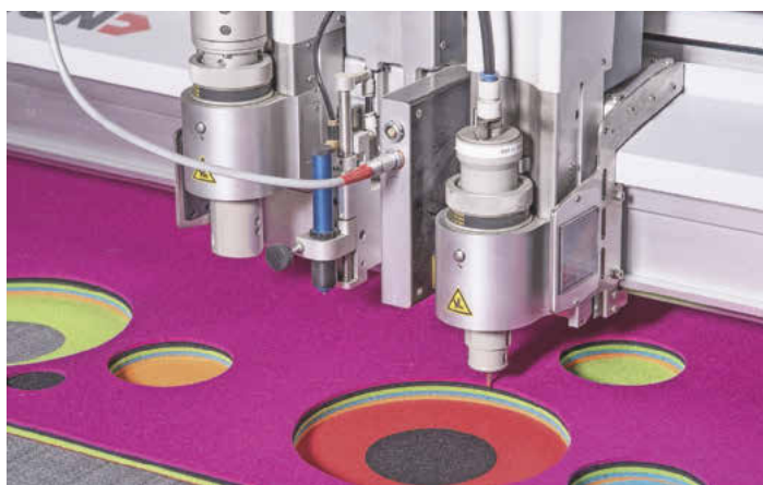
! Mit dem CNC-Cutter bietet Ackermann seinen Kunden neue Möglichkeiten, um auch ungewöhnliche Werkstoffe effizient zu bearbeiten.
