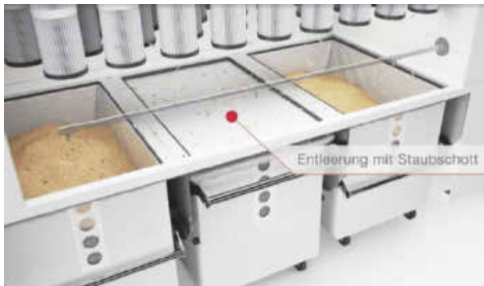
/ Saubere Sache: Das Al-Ko Clean Staubschott ermöglicht einen staubfreien Wechsel der vollen Spänebehälter.
