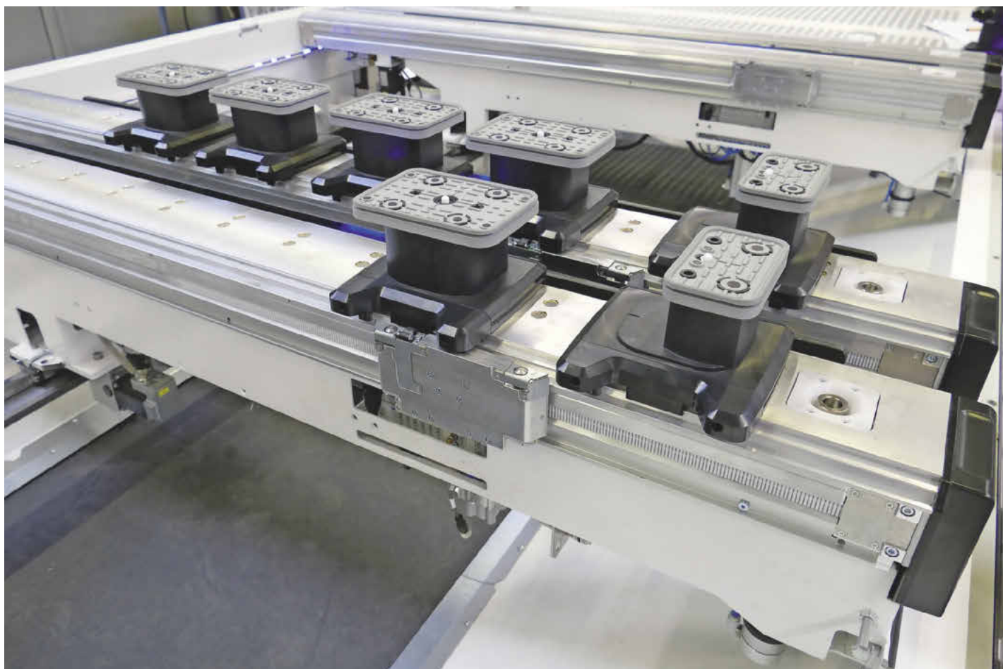
Der brandneue A-Flex-Tisch vereint die Flexibilität eines manuellen mit dem Komfort eines automatischen Tisches. Er positioniert Spannmittel und Konsolen automatisch und erlaubt gleichzeitig das freie Wechseln zwischen manuellem und automatischem Rüsten der CNC-Maschine.
