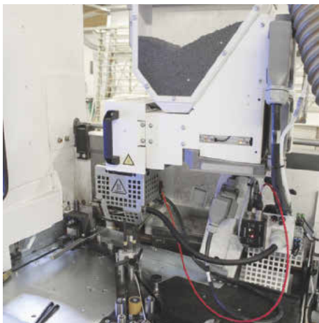
/ Mit Verleimteilen für EVA, PUR oder AirTec auf alles vorbereitet. Im Bild das Schmelzkleber-Verleimteil.
