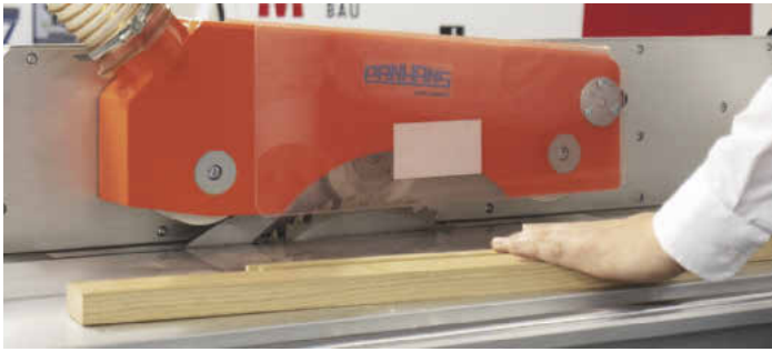
/ Mit Sicherheit staubfreier arbeiten: Der Tischkreissägen-Vorschubapparat 76 lässt sich einfach, schnell und werkzeuglos am Parallelschlag montieren.
