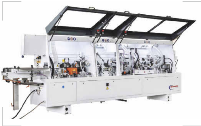
/ Die Bi-Matic-Kantenanleimmaschine Typ Prima 7.3 Plus ist komplett ausgestattet und wird über einen großen Touchscreen-Monitor bedient.
