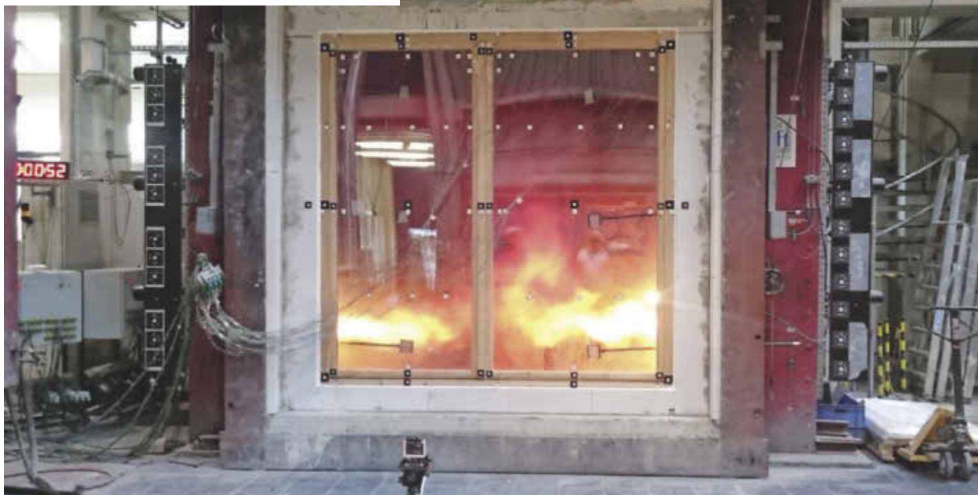
/ Das Brandschutzfenster mit Lüftungsflügeln zu Beginn des Brandversuches.
