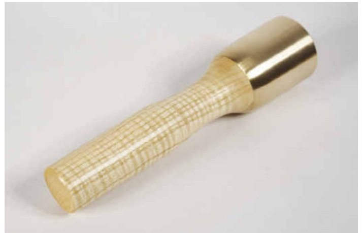
/ Damit lässt sich arbeiten: Ein gut 700 gr schwerer Klüpfel mit Messingkopf mit Griff aus geriegelter Esche für schwere Stemmarbeiten an Holzverbindungen.
