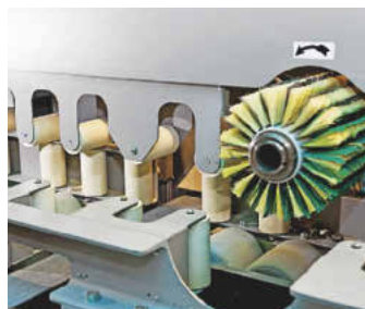
/ Die Spezialschleifmaschine Q-Fin von Martin macht den Zwischenschliff ...
