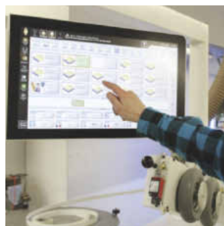
/ Großformatig mit komfortabler Bedienung: das Powertouch-Terminal an der Kantenanleimmaschine.
