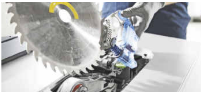
/ Sicherheitstechnik in der TSK 80: eine Kartusche, die einen Alublock per Feder ins Sägeblatt treibt, wenn es bei laufendem Betrieb in Kontakt mit menschlicher Haut kommt.
