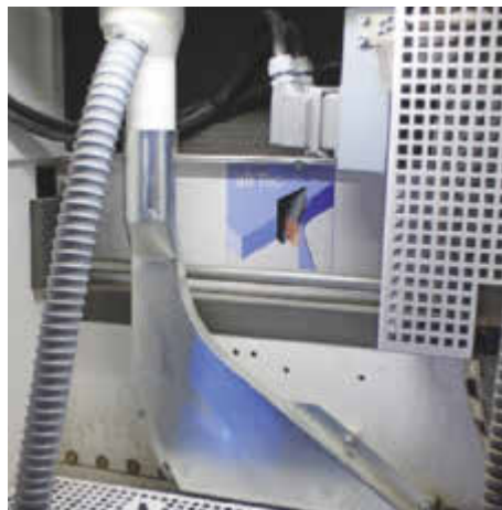
/ Schneller Wechsel per Knopfdruck: Das AirTec-Aggregat für die Nullfugentechnik mit Laserkanten.
