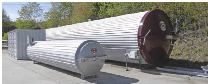
/ Die Vakuumtrockner von Eberl werden maßgeschneidert in sämtlichen Größen und Ausstattungen angeboten – von 1,7 bis über 100 m 3 Stapelrauminhalt.
