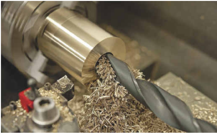
/ Beachtliche Fertigungstiefe: Auch die Metallteile aus Messing, Bronze, Edelstahl und anderen Werkstoffen werden bei Matthias Fenner Toolworks selbst gefertigt.
