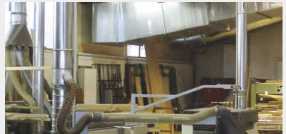
Die SEPAS-Plus-Absauganlage punktet mit ihrer hohen Flexibilität durch das Einrohrsystem.
