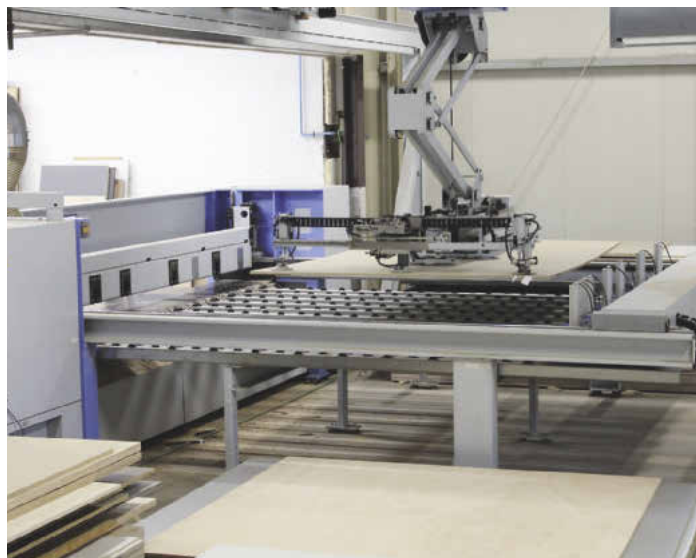
/ Manipuliert automatisch nach Programm: Der Manipulator fördert die Platten auftragsweise direkt auf die Säge.
