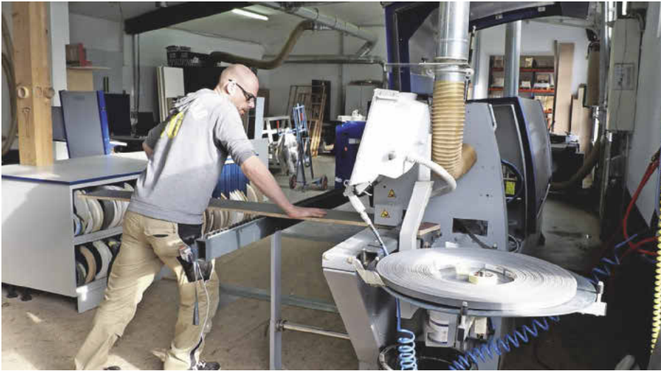
/ Auch bei der Kantenbearbeitung ist seit inzwischen drei Jahren Format4-Technologie im Einsatz. Stauf setzt dabei auf eine voll gesteuerte Kantenanleimmaschine.
