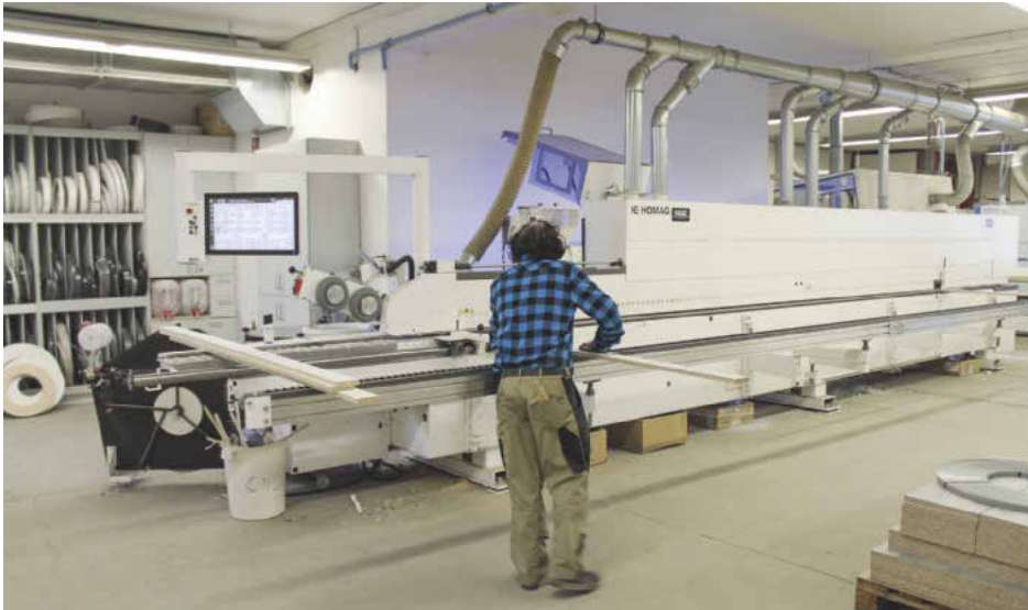
/ Präzise Kantenbearbeitung im robusten Industriestandard: Mit der Edgeteq S-500 Profiline konnte die Kantenqualität weiter verbessert und der Vorschub gesteigert werden.
